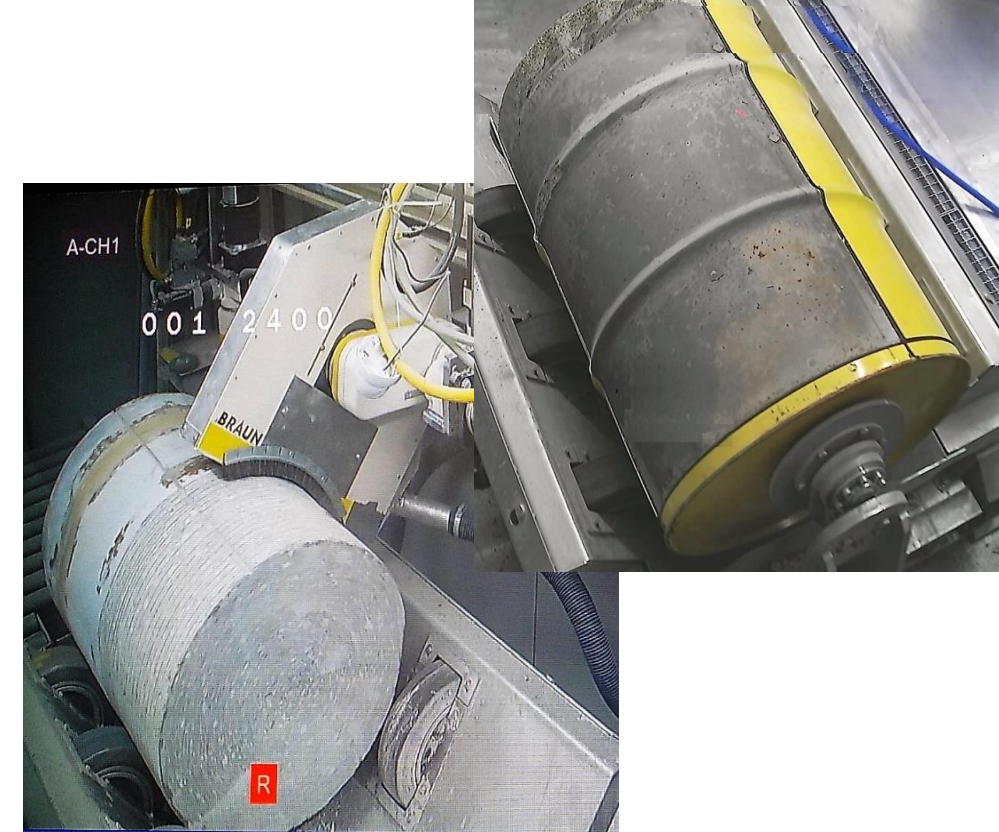
Entfernung des Betonmantels
