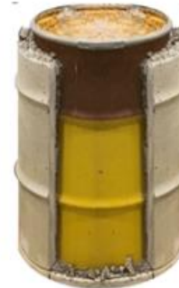
Entfernung des Betonmantels
