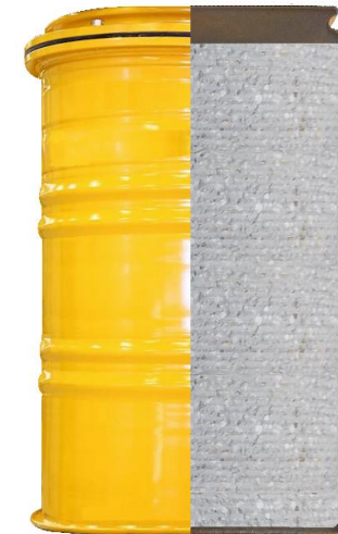
200l Fass mit homogen zementiertem Abfall (z.B. Schlämme, Salze)
