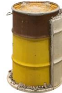
Entfernung des Betonmantels
